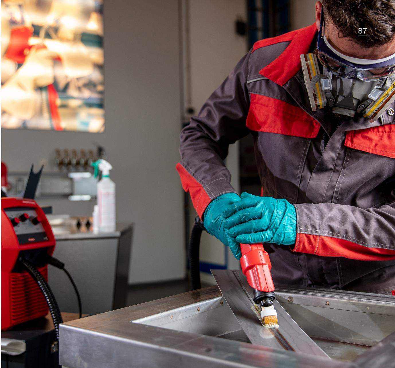
El proceso de limpieza electroquímica utiliza corriente alterna y líquido de electrolitos para eliminar y pasivar el color de revenido después de la soldadura.
